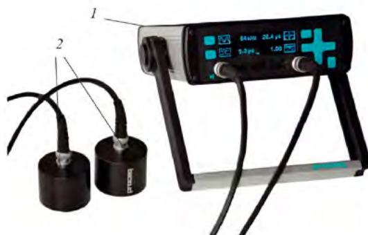
Рис. 2. Ультразвуковой прибор Pundit Lab (Proceq, Швейцария): 1 — блок управления; 2 — УЗ преобразователи
