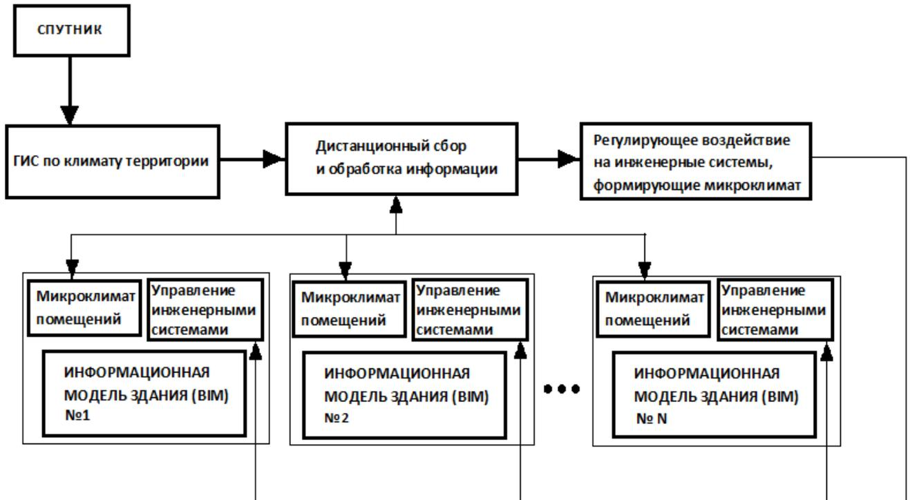
Рисунок 6.57. Схема управления микроклиматом и качеством воздушной среды при совместном и комплексном действии инженерных систем в помещениях зданий на основе физико-математических моделей воздушного, теплового и газового режимов здания с дистанционным сбором и обработкой климатической информации
