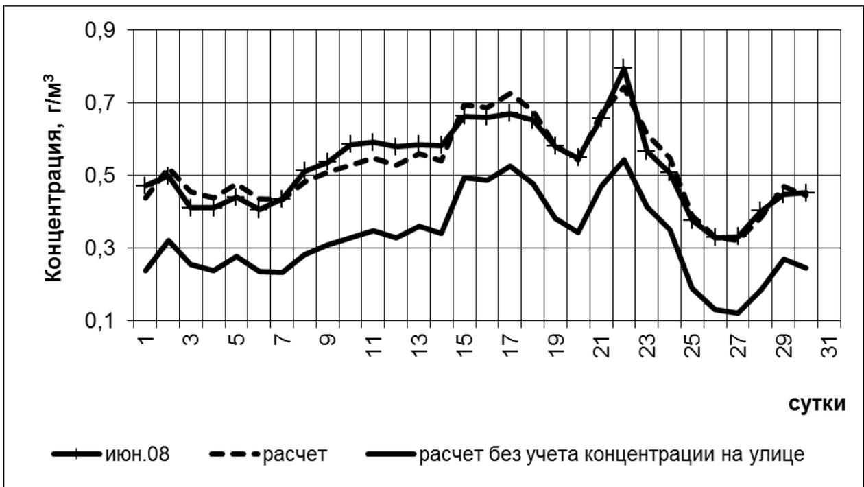
Рисунок 6.41. Изменение концентрации диоксида углерода в помещении бассейна в июне 2008 года, расчетные значения концентрации диоксида углерода
