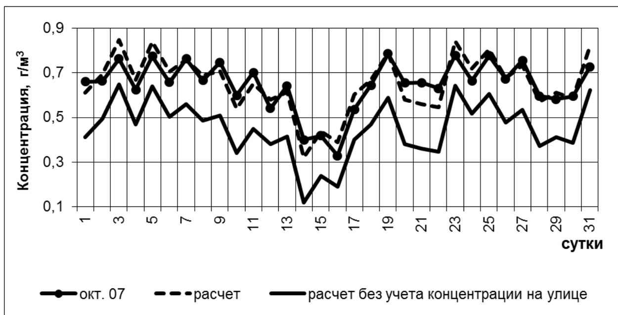
Рисунок 6.38. Изменение концентрации диоксида углерода в помещении бассейна в октябре 2007 года, расчетные значения концентрации диоксида углерода
