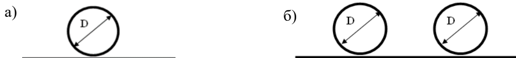
Рисунок 16 – Схемы проведенных экспериментов: а) эксперимент №1 - на поверхности дна один цилиндр, б) эксперимент №2 - на поверхности дна два цилиндра
