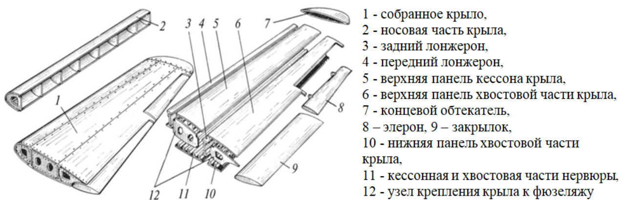
Рисунок 2.9 – Элементы конструкции крыла БПЛА
