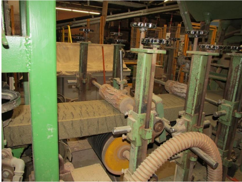
Рисунок 2. Накатка рельефа на поверхность бруса
