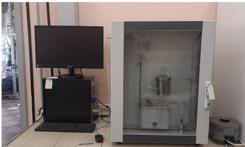
Рисунок 2. Лабораторная установка «Градиент-М» с детектором теплопроводности
