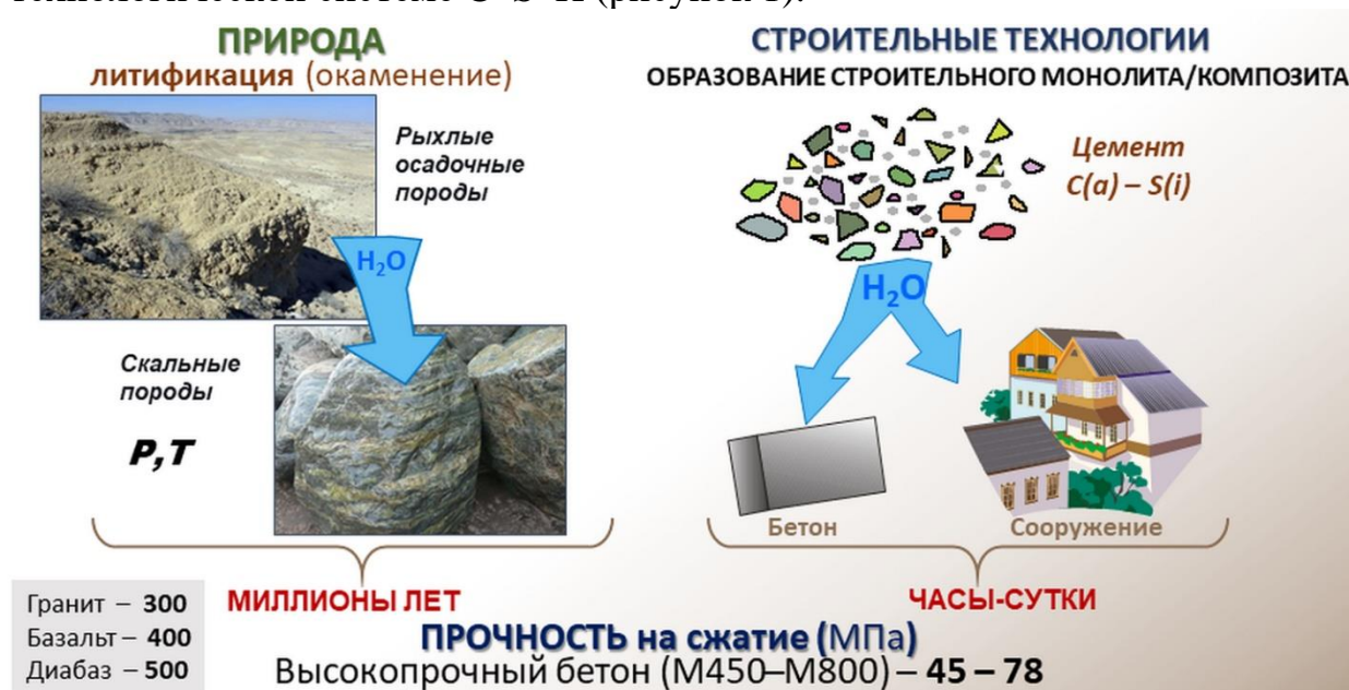
Рисунок 1. Литификация – природная модель твердения в технологии получения бетона
