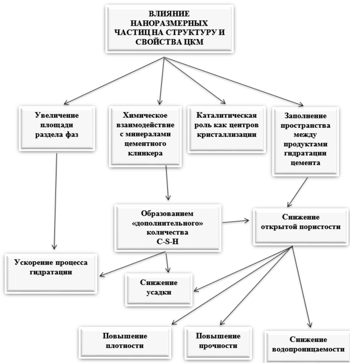
Рисунок 1. Влияние наноразмерных частиц на структуру и свойства ЦКМ
