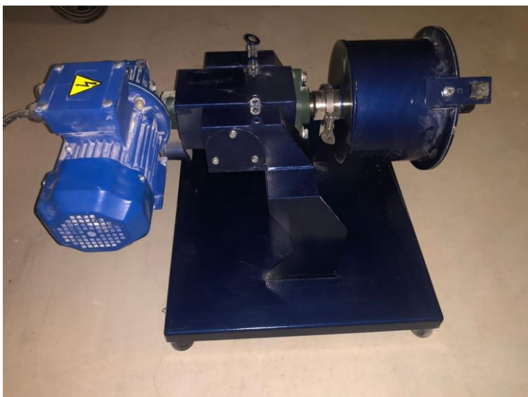
Рисунок 1. Оборудование, применяемое для получения микронаполнителя: а - лабораторная шаровая мельница ШЛМ-5; б – мелющие тела и микронаполнитель.
