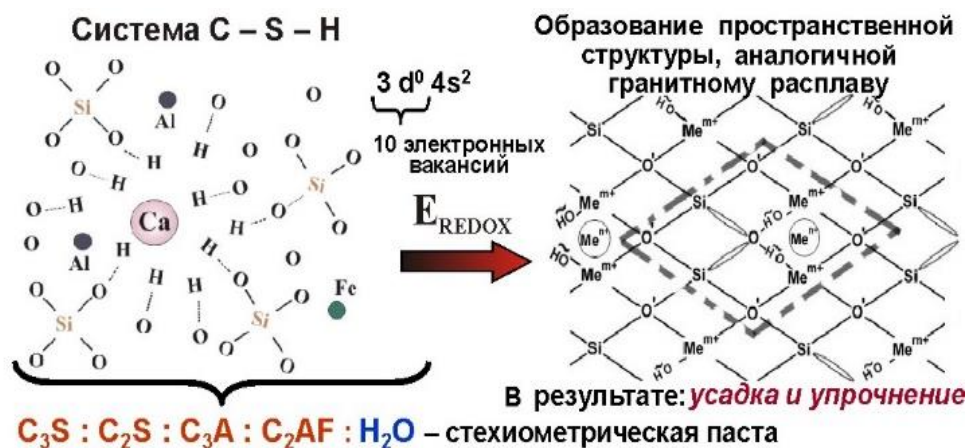
Рисунок 4. Образование строительного монолита как природоподобная модель литификации
