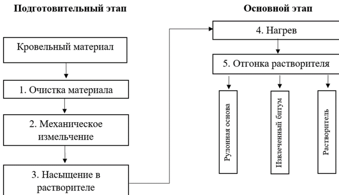
Рисунок 1. Технологическая схема получения рекуперационных битумов
