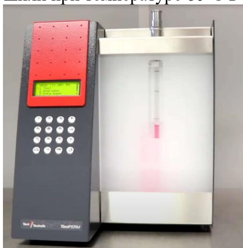
Рисунок 2. Прибор Toniperm Standart для определения удельной поверхности доломитового микронаполнителя
