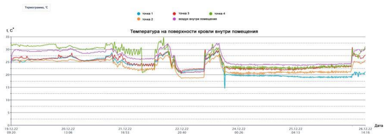
Рис. 1. Температура на поверхности кровли внутри помещения
