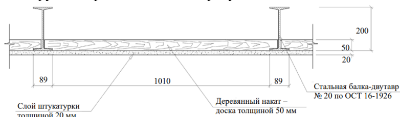
Рис. 2. Состав междуэтажного перекрытия надземного этажа жилого дома(после демонтажа конструкций полов)
