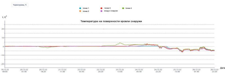
Рис. 2. Температура на поверхности кровли снаружи
