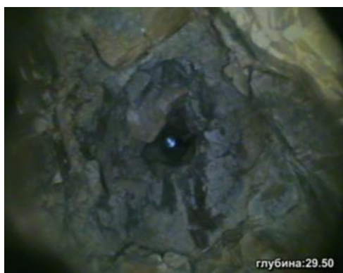
Рис. 2. Кадры видеосъемки ствола скважины: а-крупнообломочные оползневые накопления в интервале глубин 28 - 30 м; б- коренные отложения мел-палеогенового флиша.
