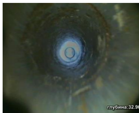
Рис. 2. Кадры видеосъемки ствола скважины: а-крупнообломочные оползневые накопления в интервале глубин 28 - 30 м; б- коренные отложения мел-палеогенового флиша.
