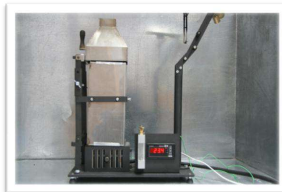
Экспериментальное определение группы трудногорючих и горючих веществ и материалов
