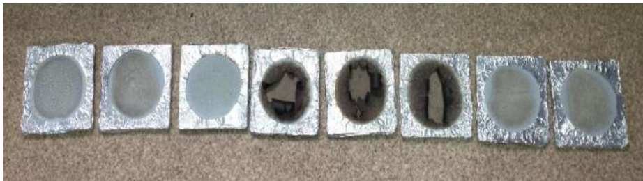
Общий вид образцов материала до и после испытаний на определение воспламеняемости
