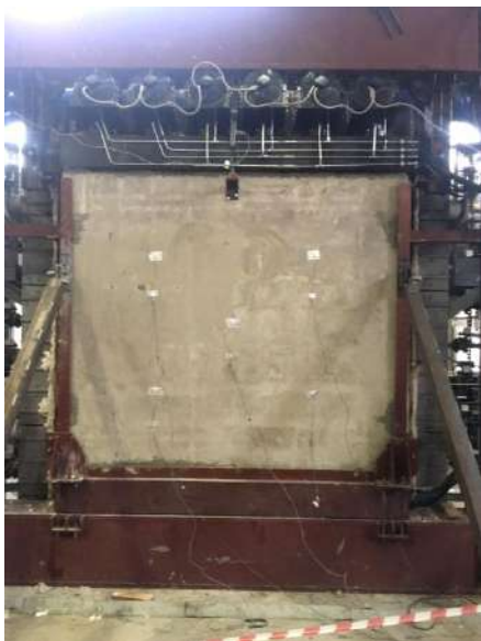
Плита перед началом проведения огневых испытаний
