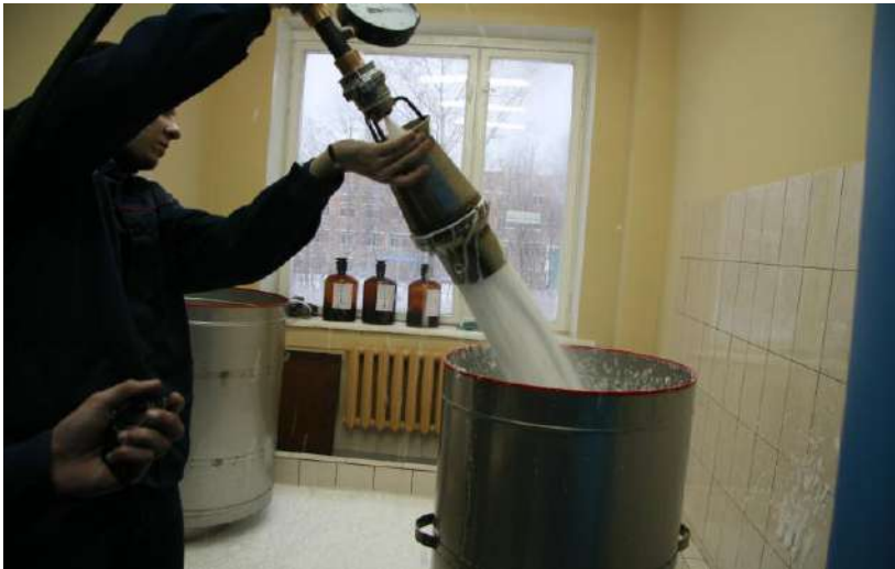
Определение кратности и устойчивости пенообразователей
