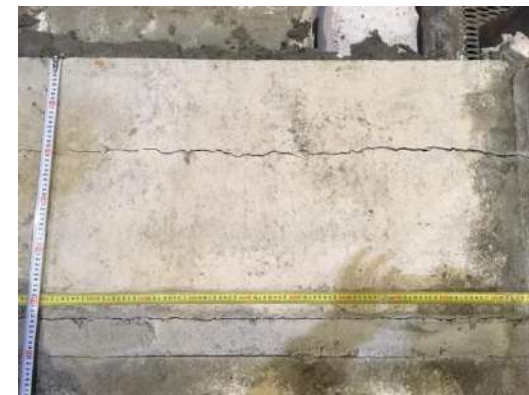
Визуальное наблюдение прогиба конструкции
