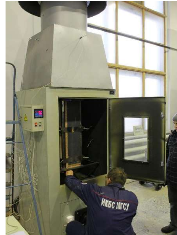
Определение группы горючести строительных материалов
