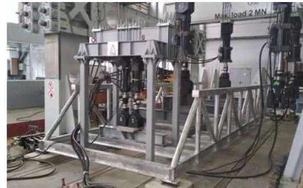
Мост 10 метров для проведения натурных испытаний в НИУ МГСУ
