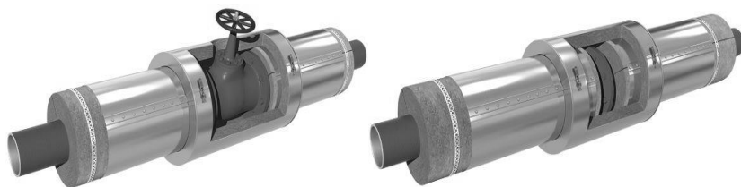
Рис. 3. Применение тепловой изоляции на запорной арматуре и фланцевом соединении с помощью матов WIRED MAT ROCKWOOL, которые могут применяться для тепловой изоляции трубопроводов наружным диаметром от 45 мм и имеют съёмную конструкцию
