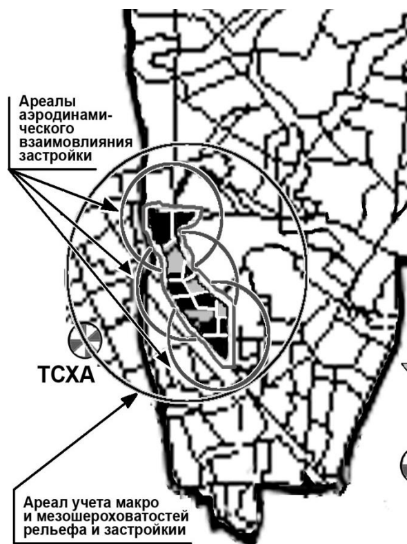
Рис. 2.2. Определение ареалов влияния застройки и шероховатостей для расчета аэрации территории, предназначенной к развитию. Проект-прогноз
