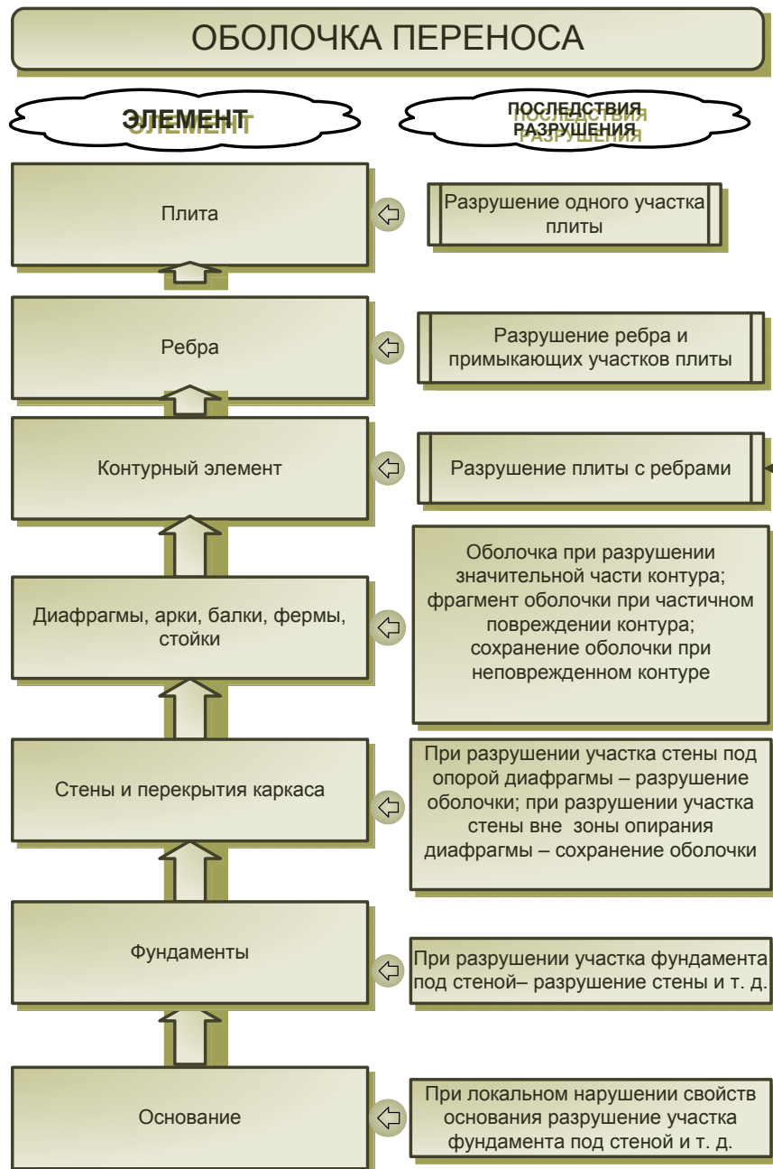
Рис. 19. Возможные последствия разрушения элементов большепролетных конструкций.
