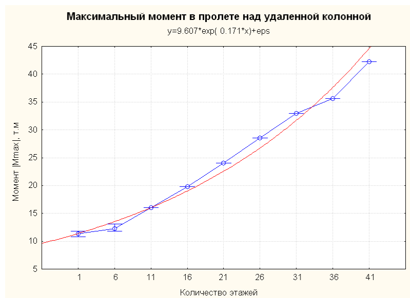
Рис. 8. Максимальный момент в пролете ригеля плоской рамы над удаленной колонной
